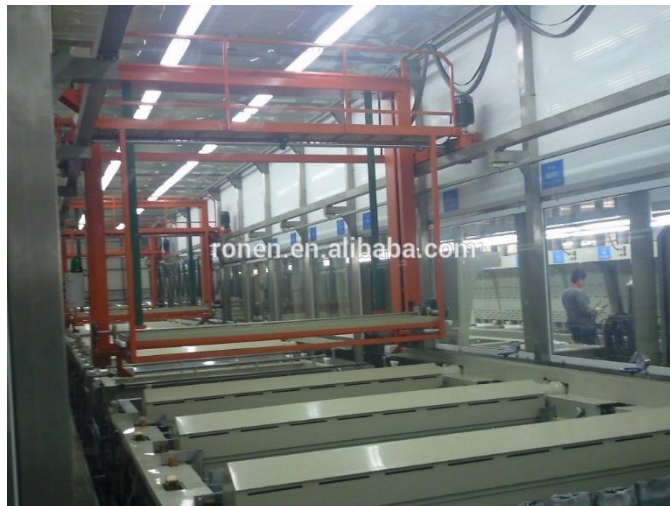
Figura 4. Disposición de cubas electrolisis
