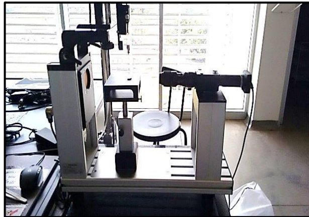
Figura 6. Vista general del equipo utilizado para ángulo de contacto. Tensiómetro Dataphysics OCA 15EC
