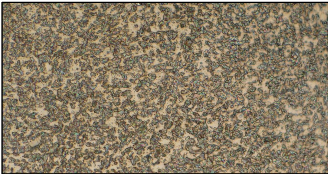
Figura 1. Microestructura de la aleación Ti6Al4V tipo mill annealed.
