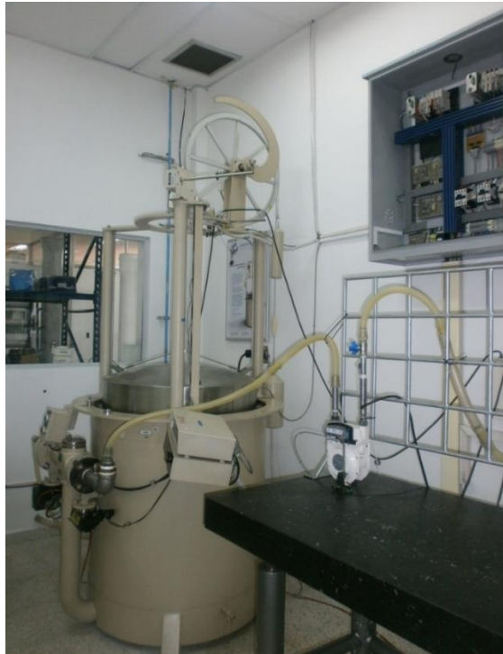
Figura 1. Campana gasométrica del Centro de metrología de fluidos de la Corporación CDT de GAS.
