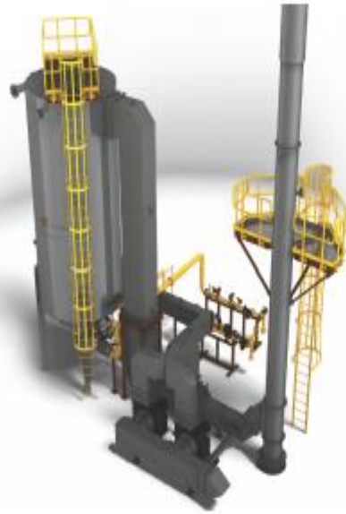
Sistema de calentamiento vertical ascendente con quemador de gas residual especialmente diseñado, ventiladores de aire de combustión redundantes y sistema de precalentamiento de aire de combustión.
