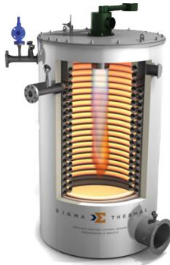
Figura 7 Vista en Corte Calentador de Aceite Térmico
