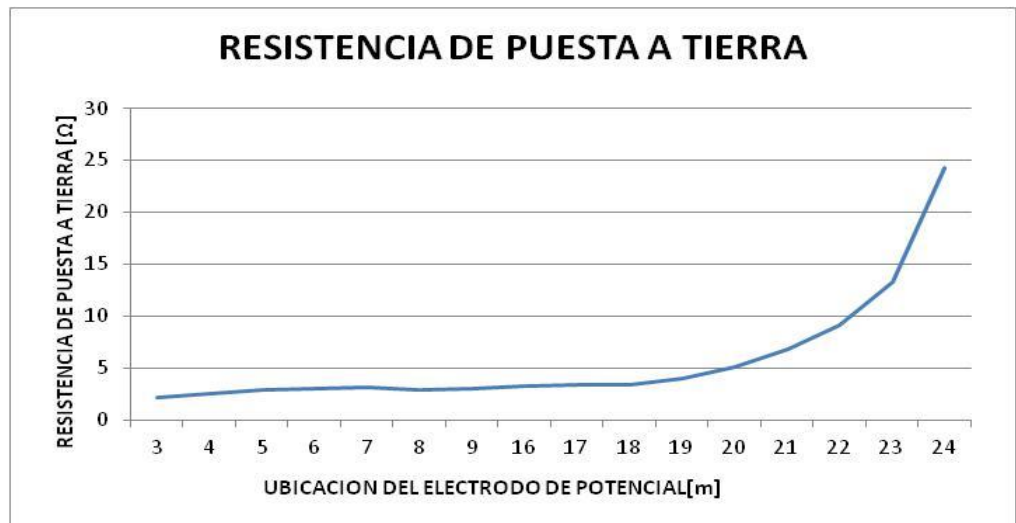
FIGURA 103. Resistencia de Puesta a tierra versus distancia electrodo de potencial
