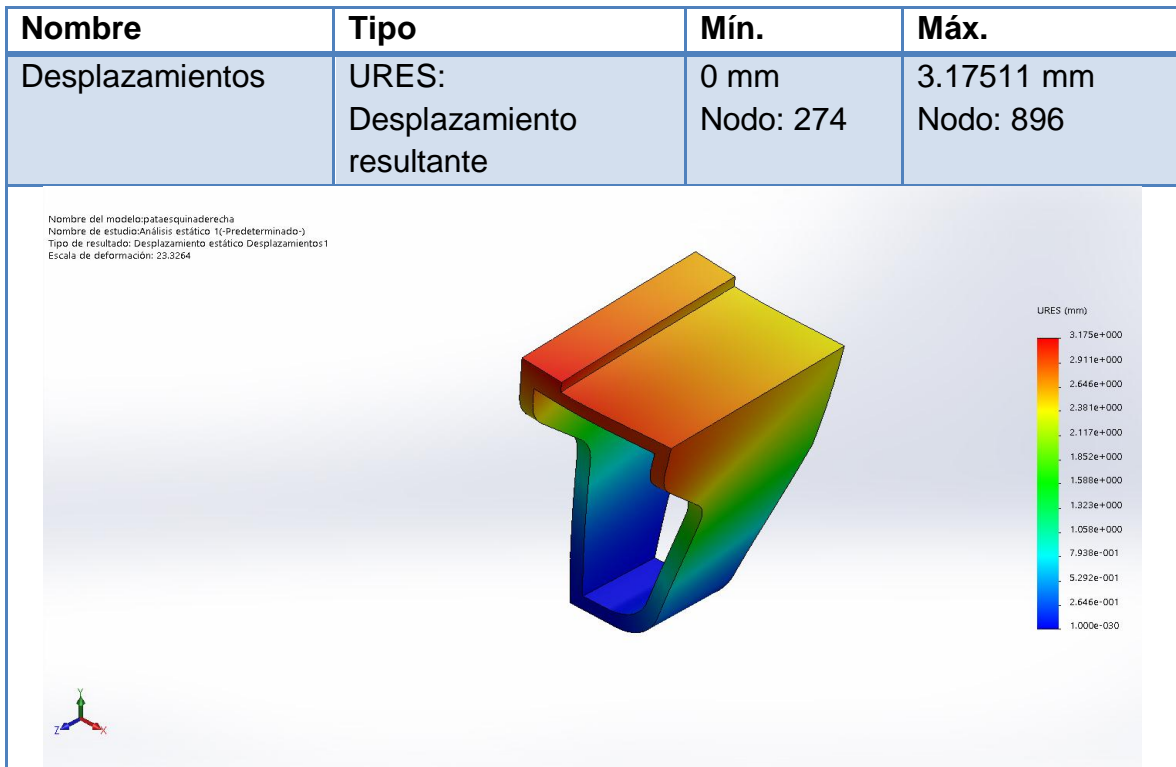
Ilustración 155. Análisis de desplazamiento del soporte-estructura formal.
