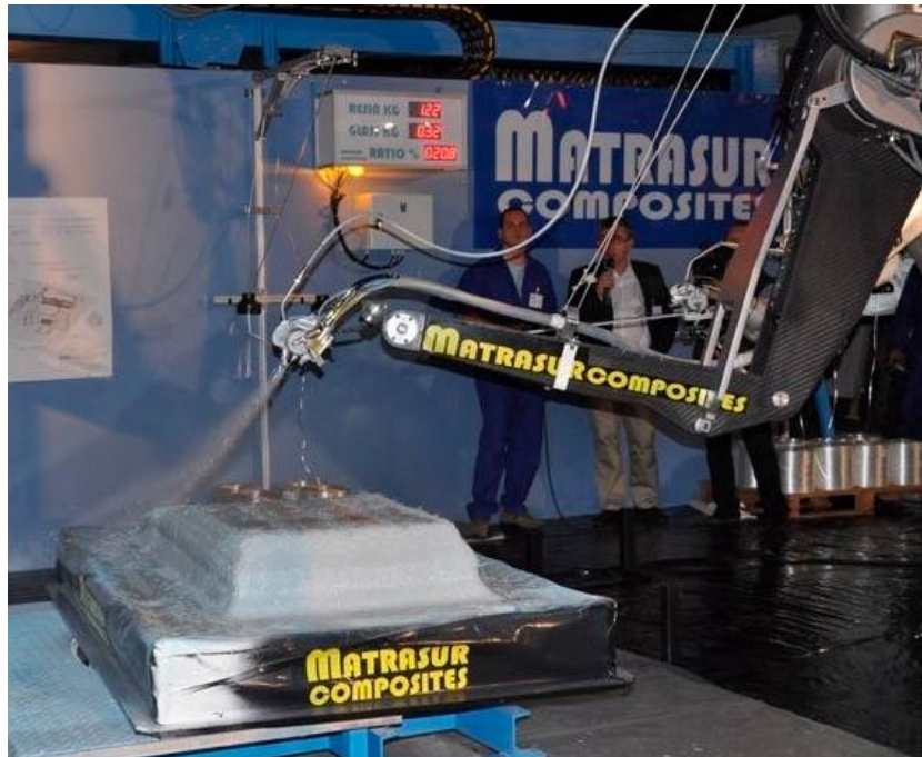
Ilustración 39, Robot articulado, Aplicación de materiales compuestos.
