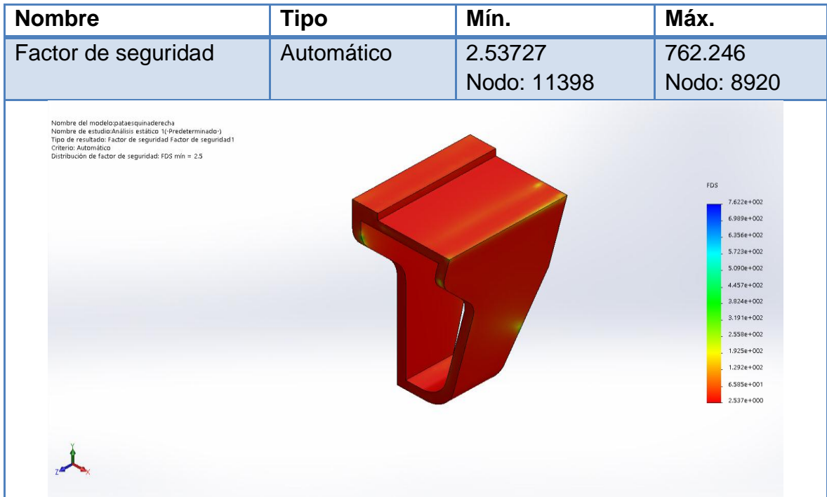
Ilustración 157, análisis de factor de seguridad del soporte-estructura formal.
