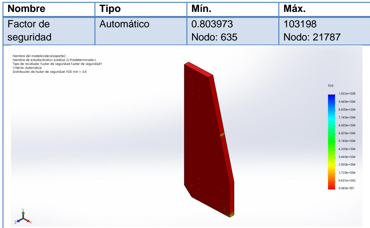
Ilustración 135. Análisis de factor de seguridad para la placa lateral.
