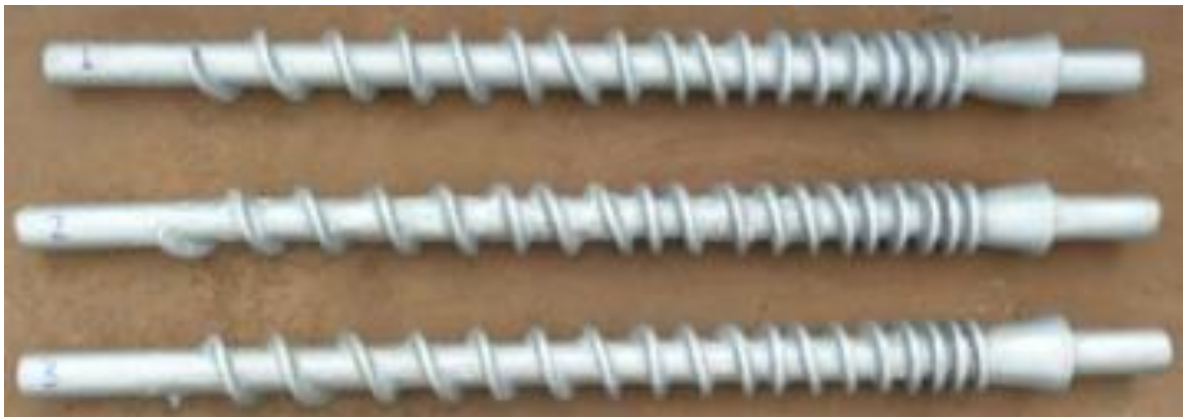
Figura 2. Ejes de tornillo sin fin que varían la holgura del eje del tornillo 14 .
