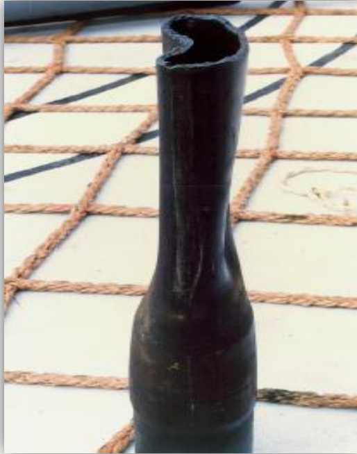
Figura 17. Efectos del colapso en las tuberías de revestimiento
