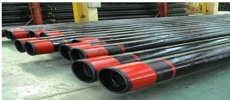
Figura 1. Tubería de revestimiento (casing)
