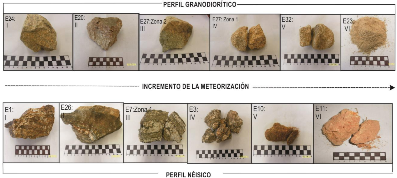
Figura 36: Transición de cada uno de los intervalos de meteorización, mediante propiedades físicas, tanto para el Perfil Granodiorítico como para el perfil Néisico.
