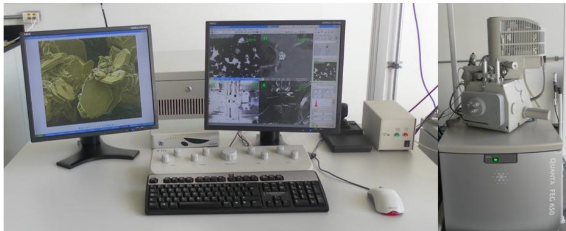
Figura 15: Equipo utilizado en Microscopia Electrónica de Barrido.
