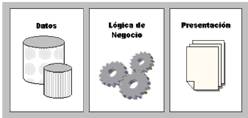
Figura 2. Arquitectura de tres capas
