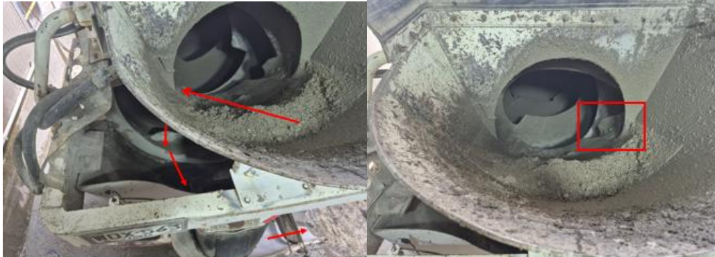
Figura 35 Inserción de la lámina de contención 2
