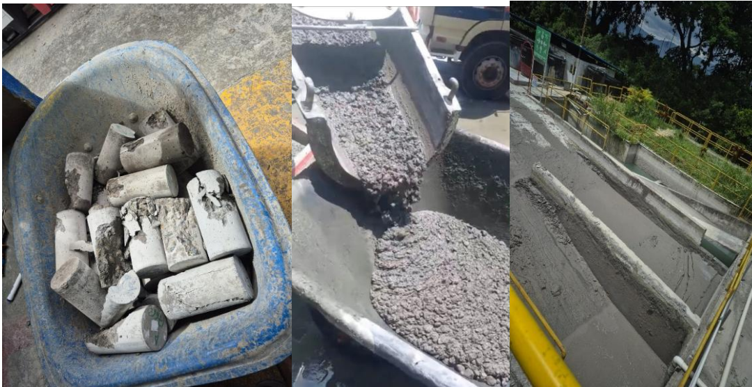
Figura 23 Pruebas de cilindros, muestras de asentamiento y residuos del lavado de mixers.
