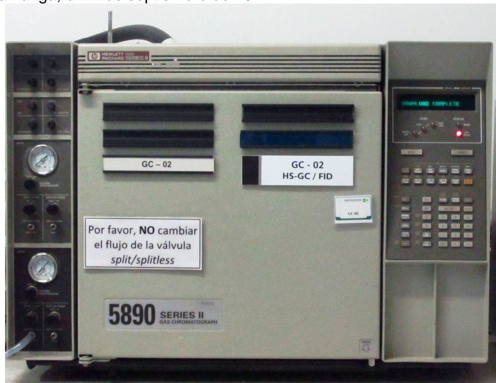
Figura 13. Cromatógrafo de gases Hewlett-Packard 5890 Series II con detector de ionización en llama (Palo Alto, California, EE.UU.), equipado con un puerto de inyección split/splitless . Lugar: Laboratorio J. J. Thomson, CENIVAM, UIS-Bucaramanga, el 11 de septiembre de 2014.
