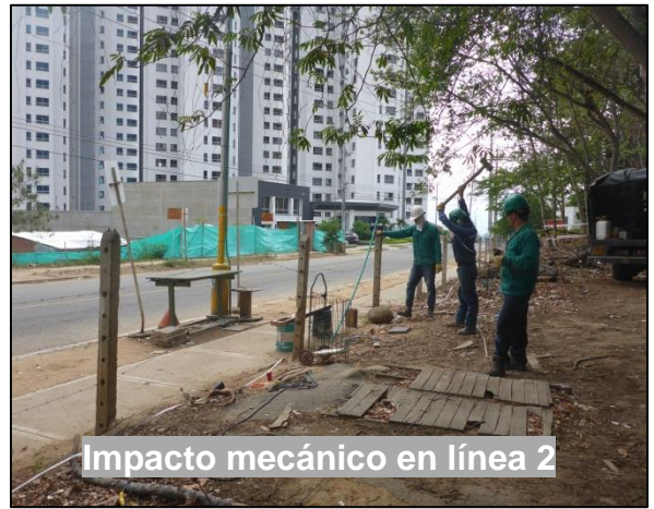
Alistamiento equipo ensayo MASW 2D - 2
