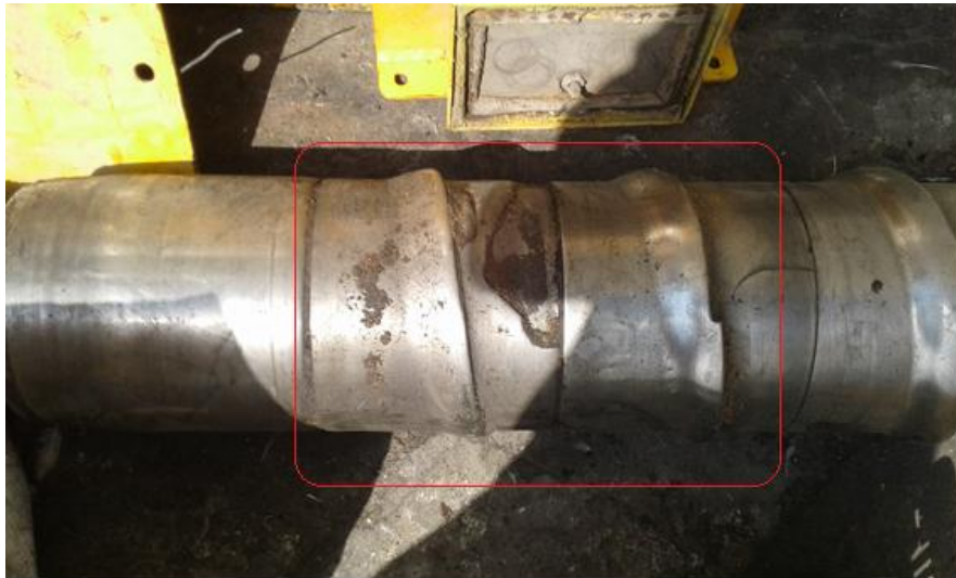
Figura 17 Desgaste de eje, desprendimiento de material
