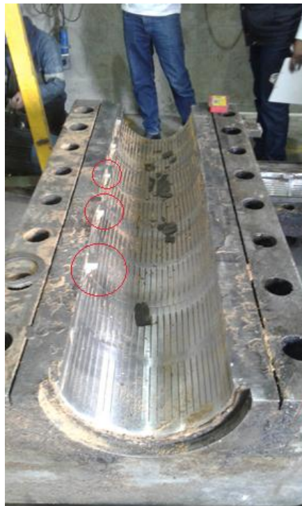
Figura 16 Avería barriles de proceso
