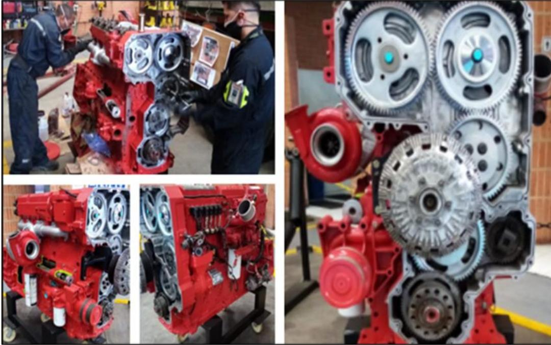
*Nota:* En este prototipo podemos identificar componentes como Turbo cargador, bomba de agua, enfriador de aceite, sistema de termostatos, sistema ISFM de combustible, compresor, bomba Biker, motor de arranque, sistema de filtración, válvulas, pistones, bielas, inyectores, actuadores y ejes de levas.
