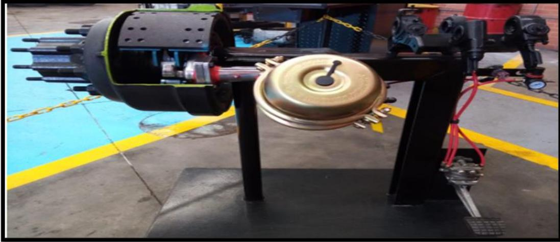
*Nota:* La importancia del aprendizaje que se pueda lograr a través de este prototipo se verá reflejada en la extensión de la vida útil de las llantas y el cuidado de los cascos, ya que del buen estado y funcionamiento del sistema de frenos dependerá la no transferencia de calor por frenado, la cual genera cristalización sobre las pestañas. Dentro de este esquema didáctico se encuentran las rodajas, los zunchos, raches (Mecánicos, automáticos), cámara de freno T30, leva y portaleva.
