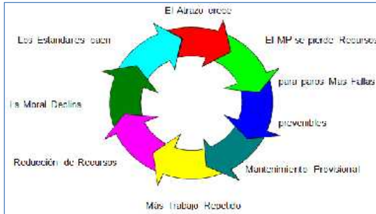
Figura 5. Circulo vicioso del mantenimiento.
