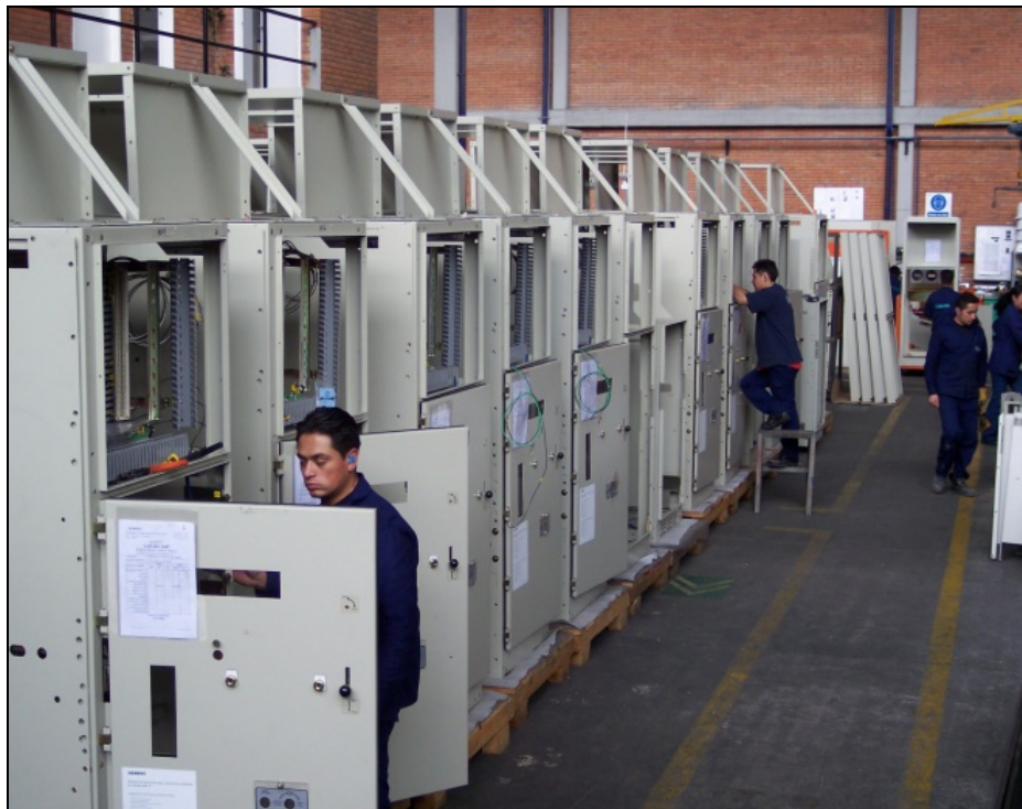
Figura 3.8. Cableado de Tableros
