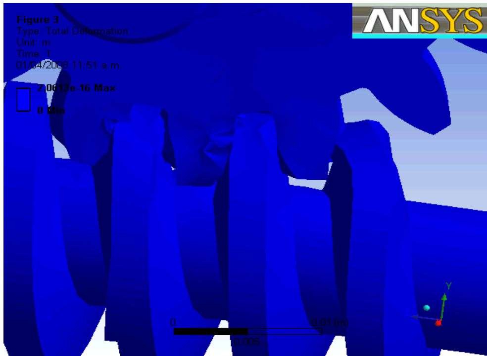
Figura 57. Deformaciones en el conjunto corona y tornillo
