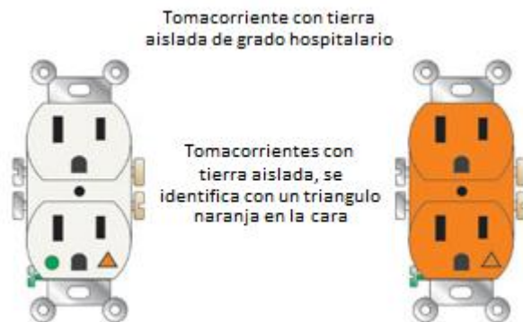
Figura 19. Tomacorriente con puesta a tierra aislada
