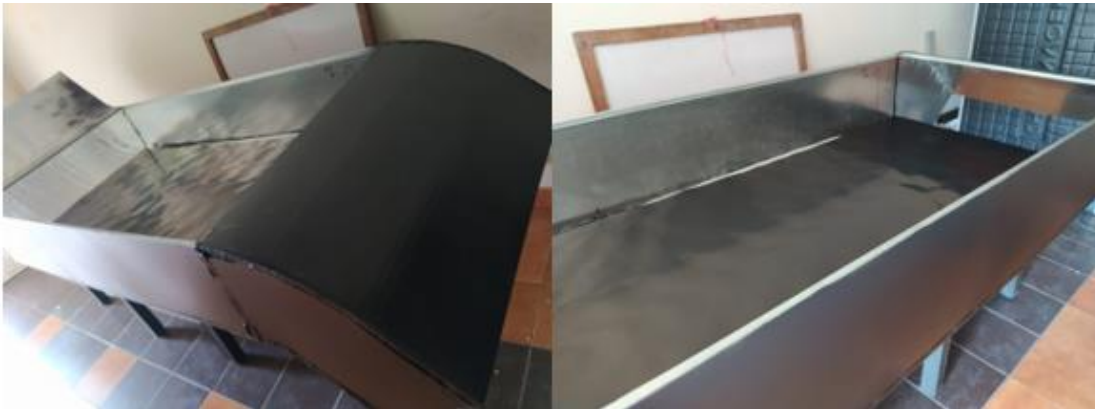
Figura 8. Estructura de lámina galvanizada y lana mineral
