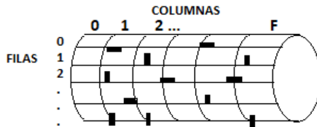
Figura 38: Posición de pines en el tambor electromecánico (DRUM)
