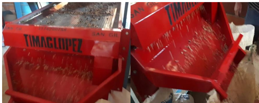
Figura 7. Monitor de clasificación TIMAG. Adaptado de Timag Lopez S.A.S. (s.f.). Recuperado de http://www.timaglopez.amawebs.com/
