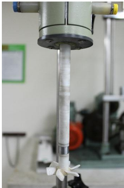
Figura A-2. Eje y electrodo cilíndrico de acero AISI 4330.
