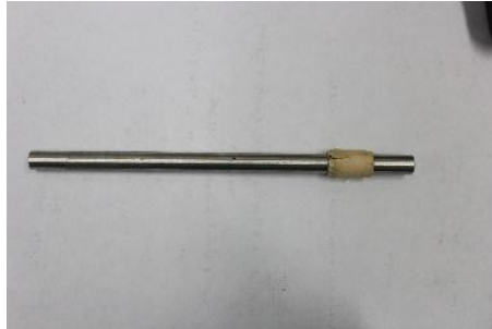
Figura A-1. Contraelectrodo de acero inoxidable AISI 316
