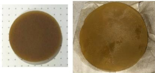
Figura 34. Comportamiento del caucho ante la absorción de gasolina.
