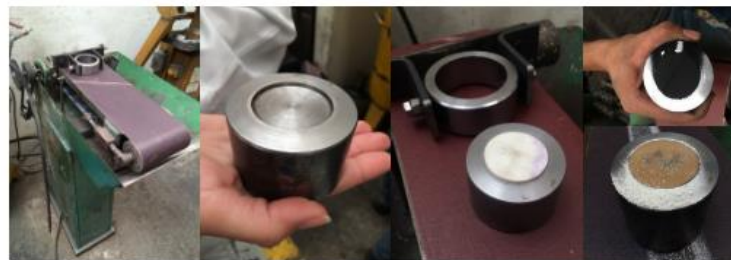
Figura 20. Prueba de abrasión realizada a materiales comerciales y PU sintetizado.
