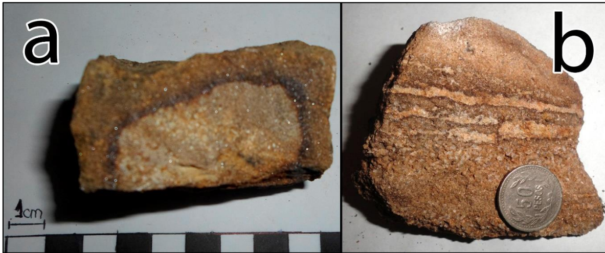
Figura 56. a) Sublitoarenita Formación Areniscas De Socha. Muestra de mano de las coordenadas X: 1143239, Y: 1143364. b) Gradación normal del tamaño de grano en las arenitas.
