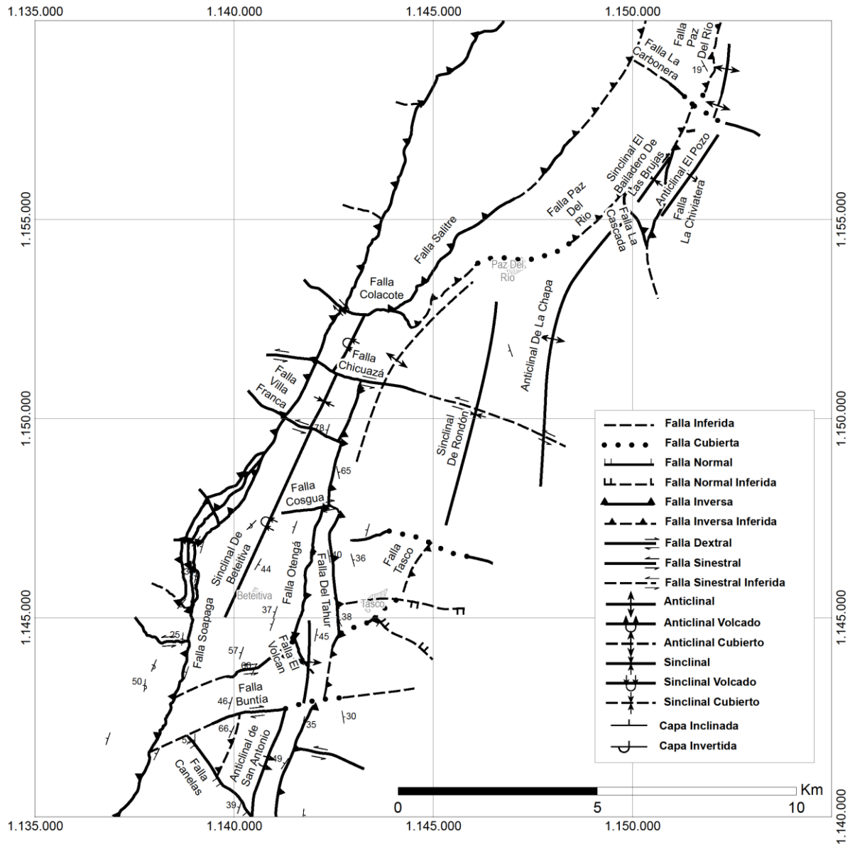
Figura 99. Mapa estructural de la zona de estudio. Cabe resaltar la presencia en toda la zona de fallas de rumbo que segmentan las estructuras como parte de la deformación transpresional derivada de la falla Bucaramanga.
