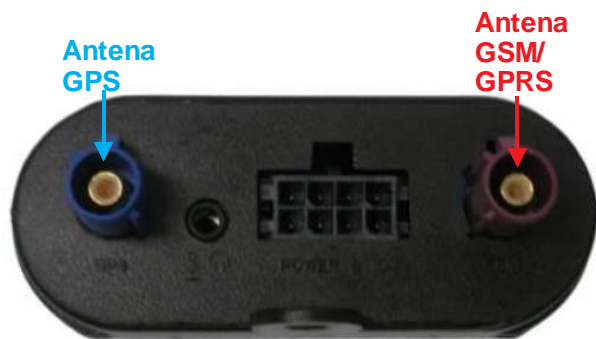
Figura 6. Conectores de las antenas.
