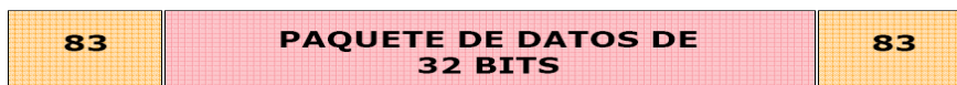
Figura 42. Trama de datos para la señal de alarma de sobrecorriente en la fase 'b' 59 .
