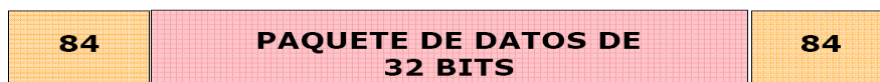
Figura 43. Trama de datos para la señal de alarma de sobrecorriente en la fase 'c' 60 .
