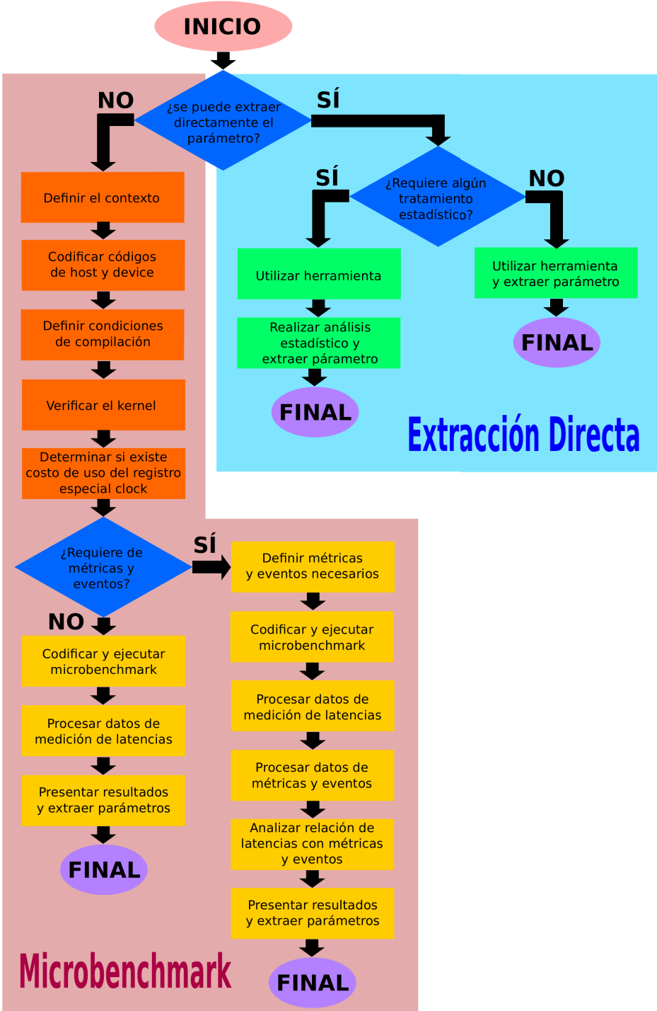
Figura 14: Metodología planteada para la extracción de los parámetros. Los procesos de la metodología se pueden agrupar según el parámetro se pueda extraer de manera directa o si se requiere implementar un microbenchmark para su extracción.
