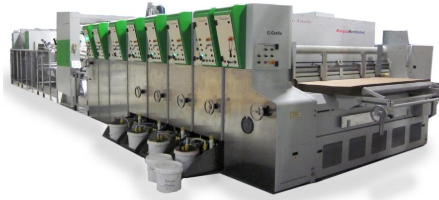
Gráfico 7. Impresora tipo Flexo Folder Gluer Marquip Ward.
