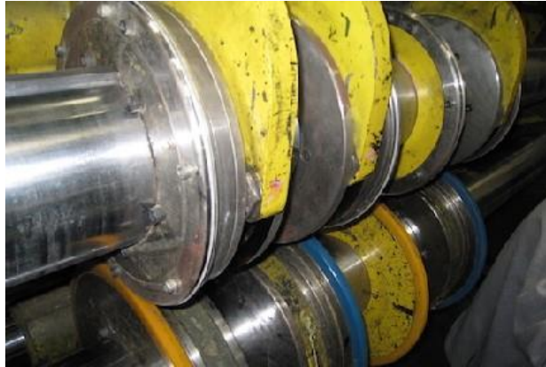
Gráfico 10. Juego de scores Macho y Scores Hembra impresora tipo FFG
