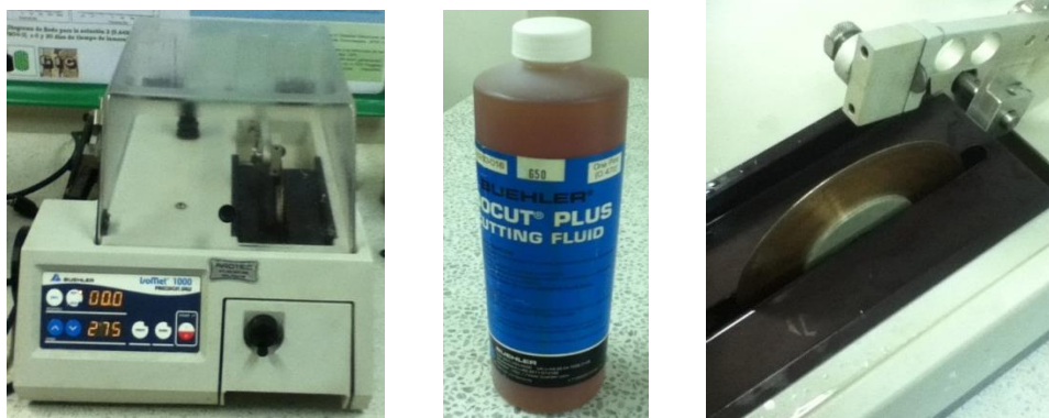
Figura 5. Equipo e implementos (a) Microcortadora BUEHLER (b) Lubricante Puro (c) Disco de corte 15 HC.
