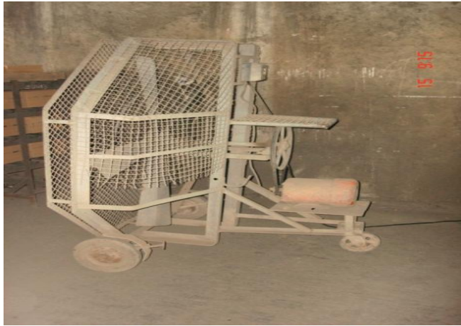
Figura 15. Ventilador de Secado Natural.
