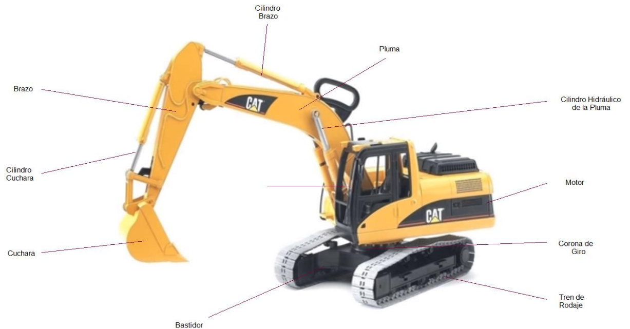
Figura 32. Partes Retroexcavadora 312D
