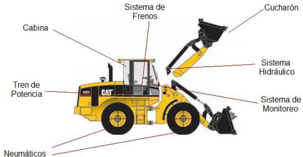
Figura 36. Partes del Cargador Caterpillar 930G
