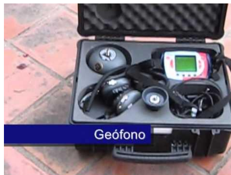
Figura 17. Aparato para detectar fugas en tuberías.
