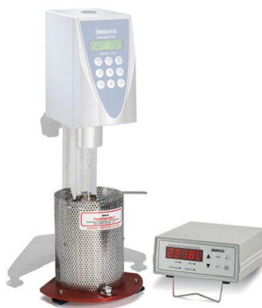
Figura 57. Reómetro Brookfield modelo DVI empleado para mediciones de viscosidad de fracciones Destilados y Residuos.
