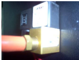
Figura 8.2 Acople entre válvula y manguera
