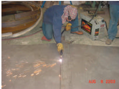
Figura 7: Corte con plasma. Fabricación de Tanque para maduración de cacao
