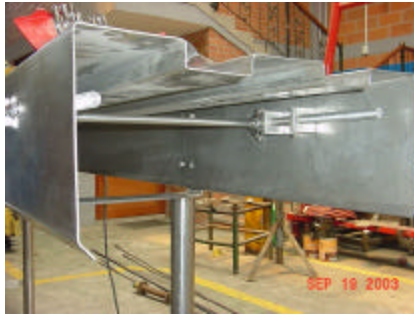
Figura 10: Perfil de láminas con dobleces. Fabricación de bandas transportadoras
