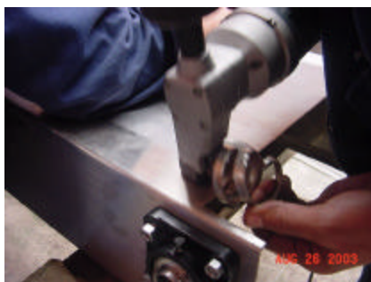
Figura 9: Corte con cizalla eléctrica de mano. Fabricación de bandas transportadoras
