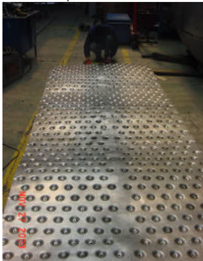
Figura 11: Láminas repujadas. Fabricación de tanques
