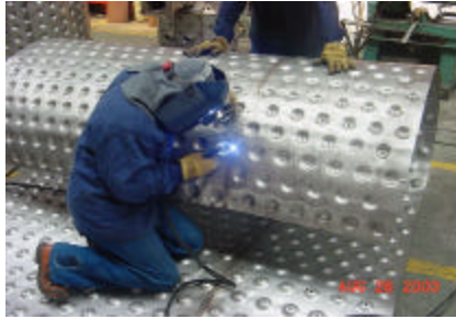
Figura 18: Soldadura TIG. Fabricación de chaqueta de vapor para tanque
