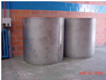
Figura 12: Lámina Cilindrada. Fabricación de Tanques
