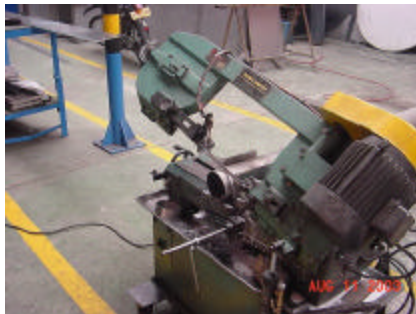
Figura 8: Corte con sierra de cinta. Fabricación de bases para tanque
