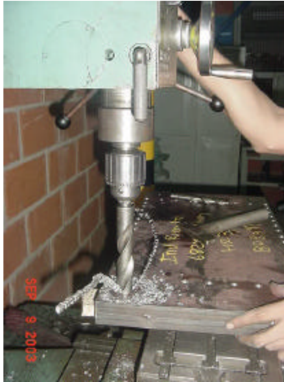
Figura 15: Taladrado. Fabricación de caja de engranajes para máquina hiladora de quesos
