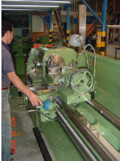
Figura 13: Torneado. Mecanizado de partes para máquina lavadora de cantinas
