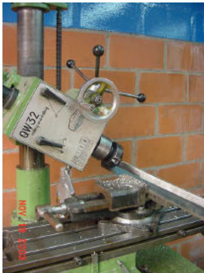
Figura 16: Fresado. Fabricación de brazos mezcladores para máquina hiladora de quesos
