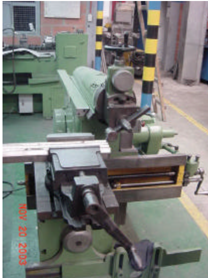
Figura 14: Cepillado. Mecanizado de partes para máquina hiladora de quesos
