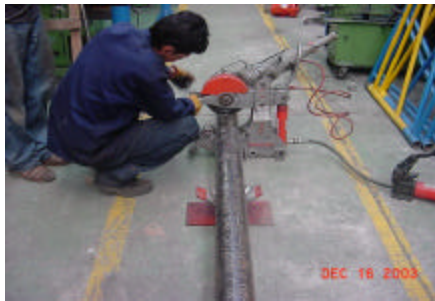
Figura 21: Punteado, rematado de soldadura y grateado.
