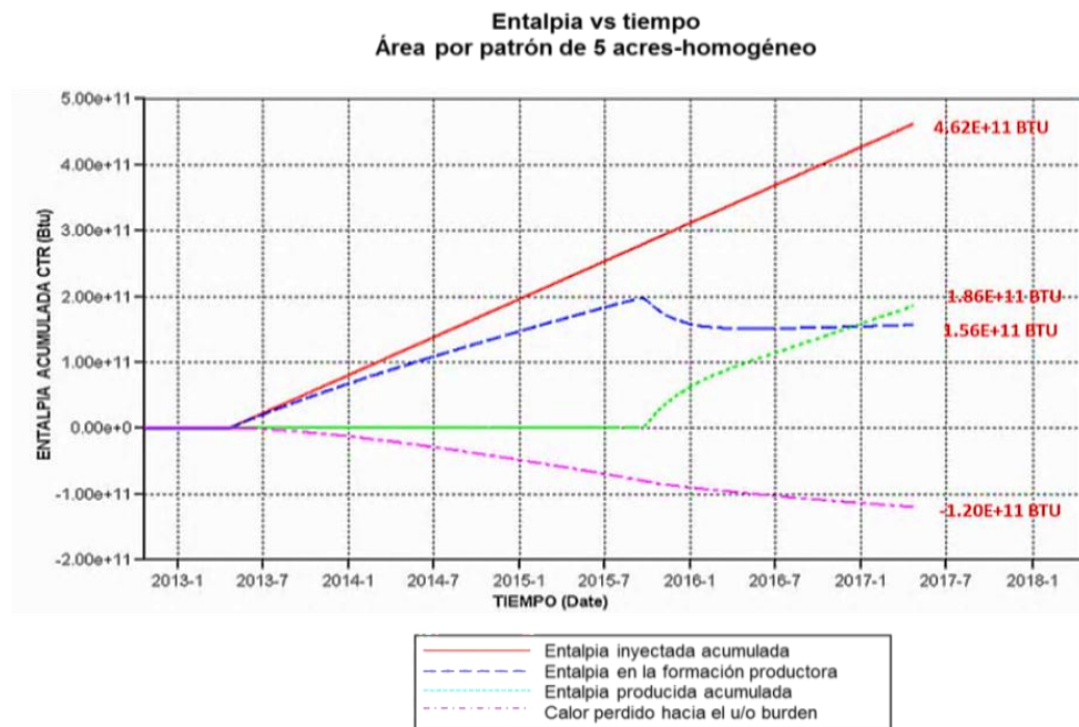
Figura 41. Entalpia en función del tiempo para un yacimiento homogéneo con un área por patrón de 5 acres
