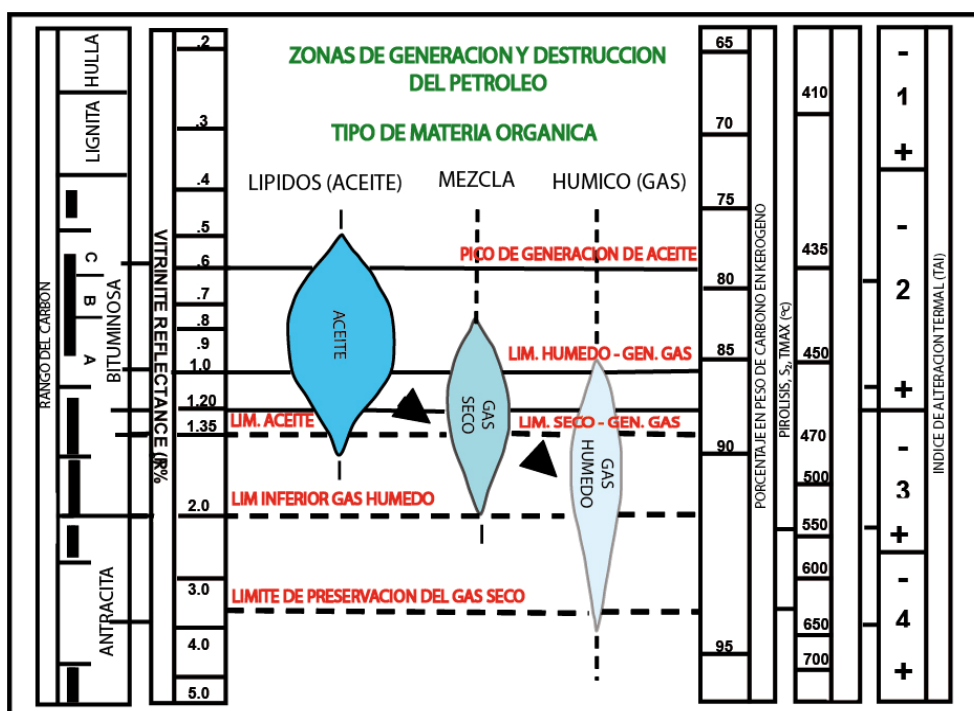
Figura 14. Correlación de técnicas orgánicas para determinar paleotemperaturas e índices de maduración. (Tomado de Tissot, 1984)
