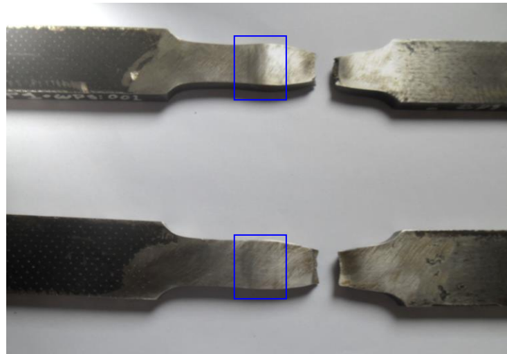
En el recuadro azul se muestra la zona correspondiente al cordón de soldadura.
