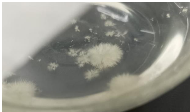
Figura 10. Cristales de JL-1 en forma de agujas alargadas.
