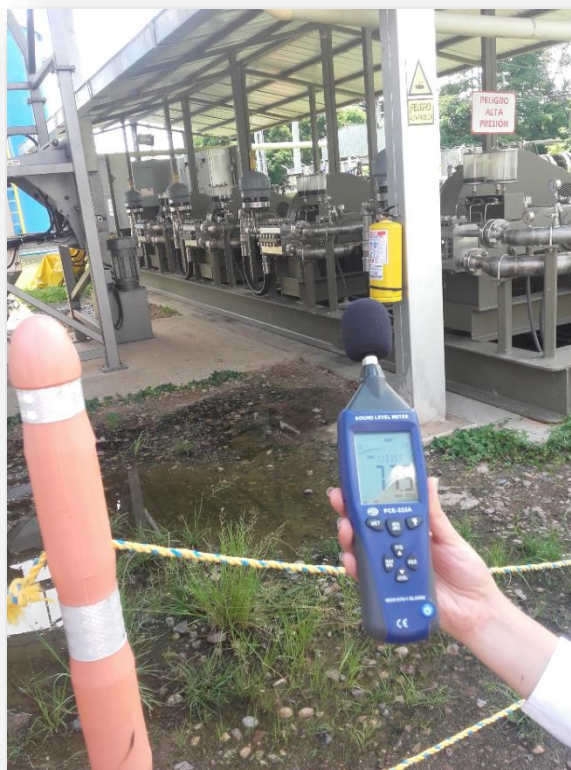
Figura 19. Utilización del sonómetro en el campo Casabe
