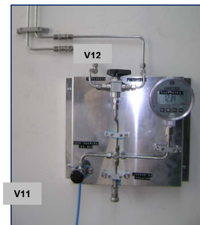
Figura B3. Diagrama acople manómetro digital al sistema de presurización.
