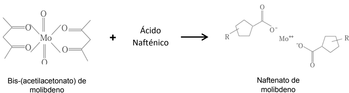
Figura B1. Modelo reacción para obtener el naftenato de molibdeno.
