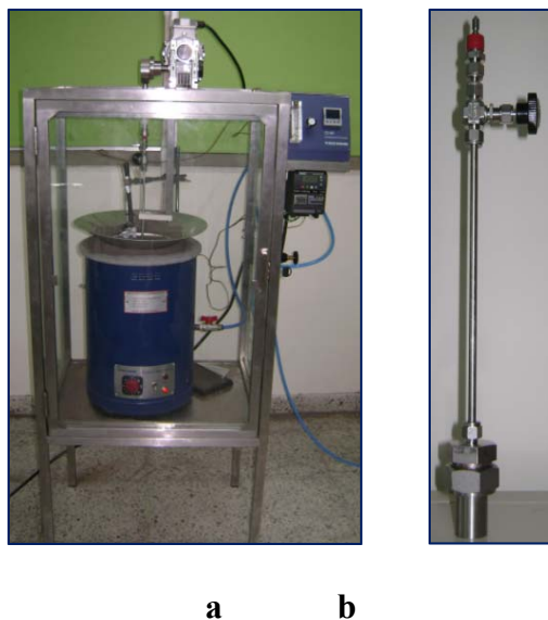
Figura B4. Sistema de agitación: a- Baño de arena fluidizado SBS-4 con controlador TC-9D y b- microreactor batch en acero inoxidable.
