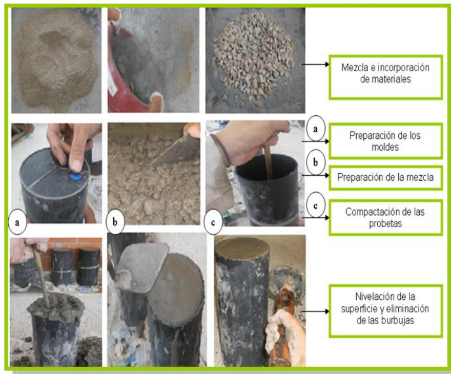
Figura 14. Proceso de fabricación de probetas cilíndricas de concreto.
