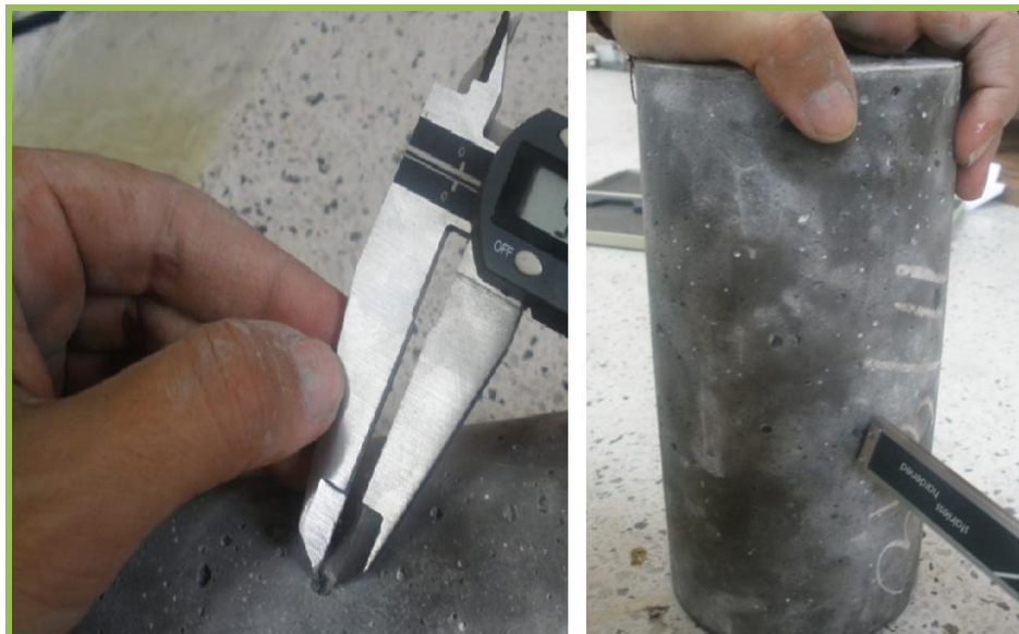
Figura 20. Observación de los poros en las probetas de concreto.
