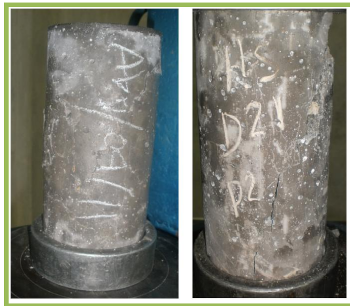
Figura 12. Fractura Cónica de las probetas cilíndricas de concreto.
