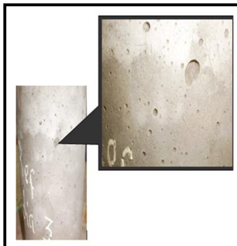
Figura 17. Porosidad abierta a la superficie de una probeta P1.
