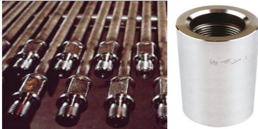
Figura 6.2 Cuerpo y unión de varillas convencionales
