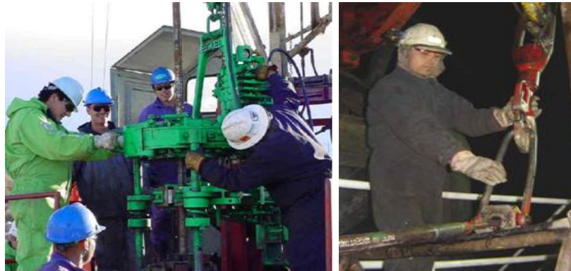
Figura 6.1 Imágenes de instalación varilla hueca
