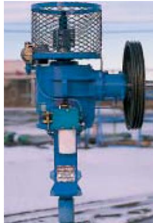
Figura 7.5 Cabezal con caja reductora para motores de combustión interna
