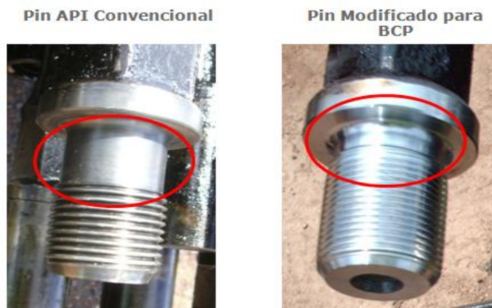
Figura 6.3. Varillas convencionales con pin modificado.
