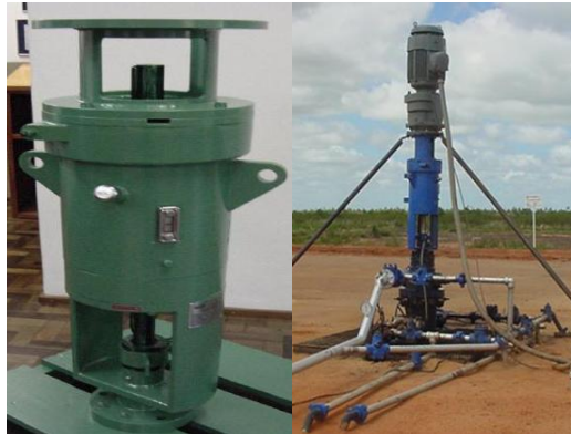
Figura 7.2 Cabezales de eje solido aplicado a motoreductor
