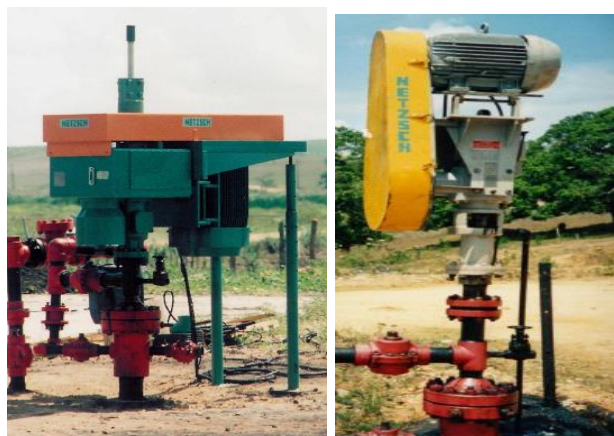
Figura 7.4. Cabezales con caja reductora
