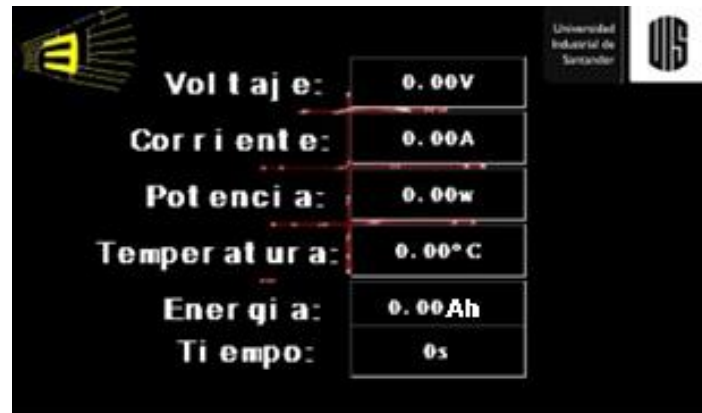
Figura 25. Pantalla de visualización de variables de descarga de la batería.
