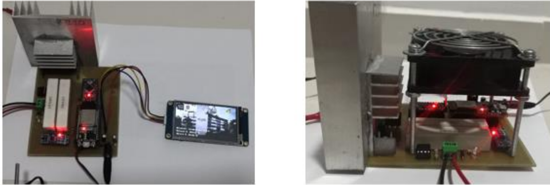
Figura 31. Prototipo final de la carga electrónica
