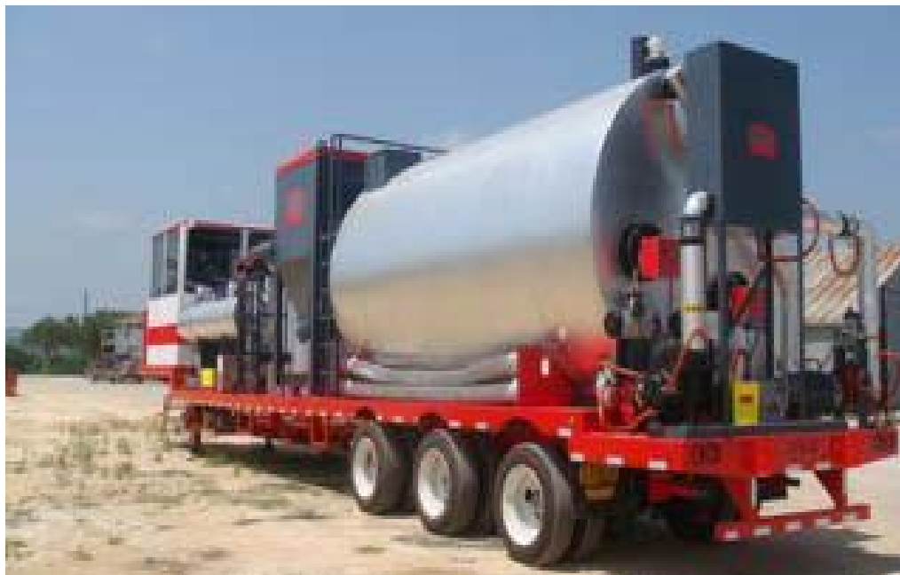
Figura . 35. Planta de producción de asfalto- caucho - MPI
