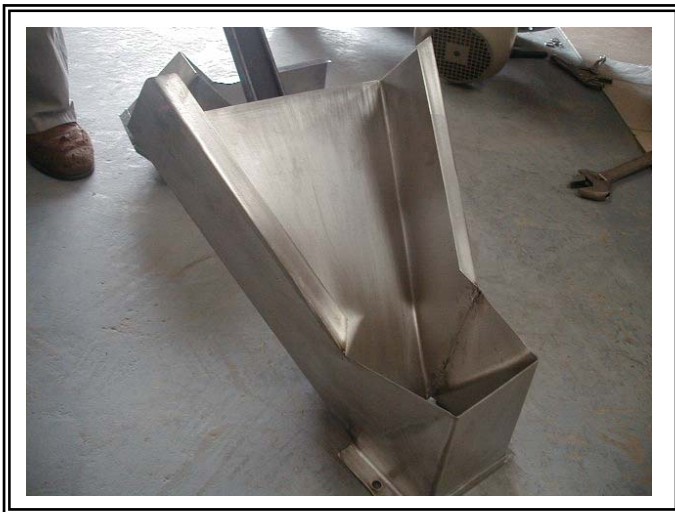
Figura D4 al anexo No. 4 Tolva de alimentación del caucho
