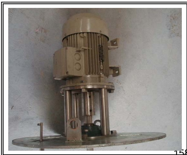
Figura D7 al anexo No. 4 Motor del mezclador
