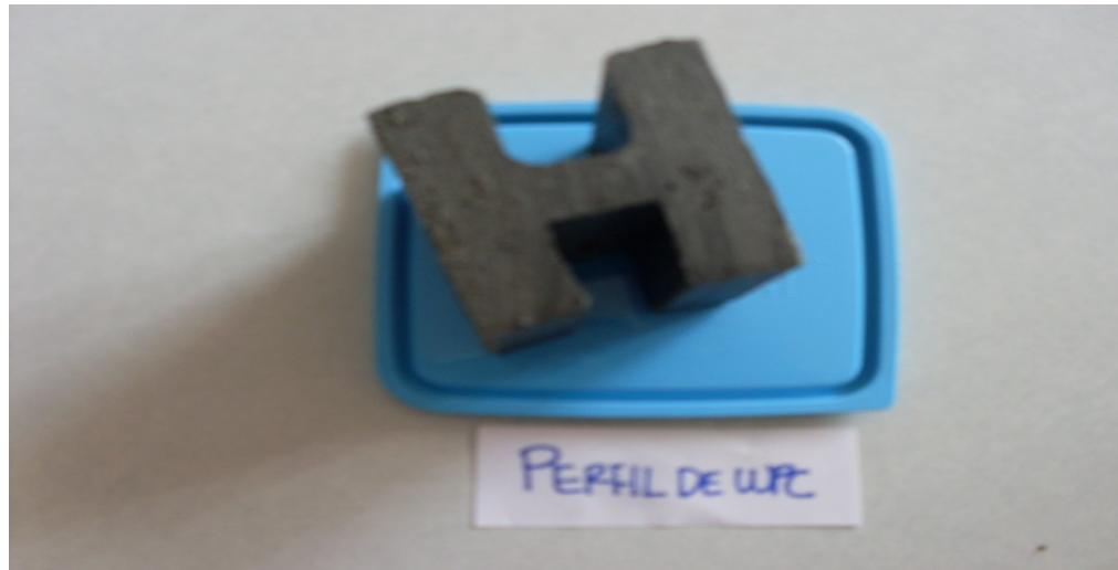
Figura 48. Perfil de WPC con proceso de inyección
