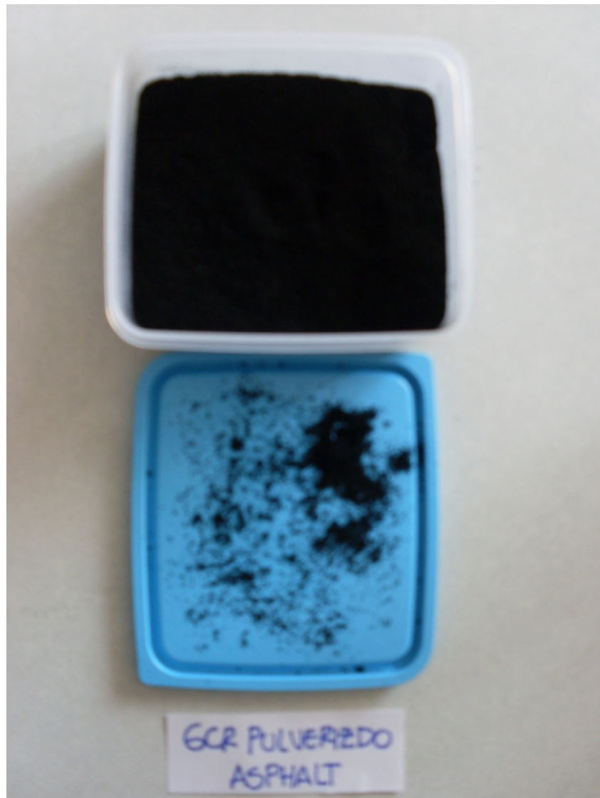
Figura 17. Imagen de Muestra de Asphalt.
