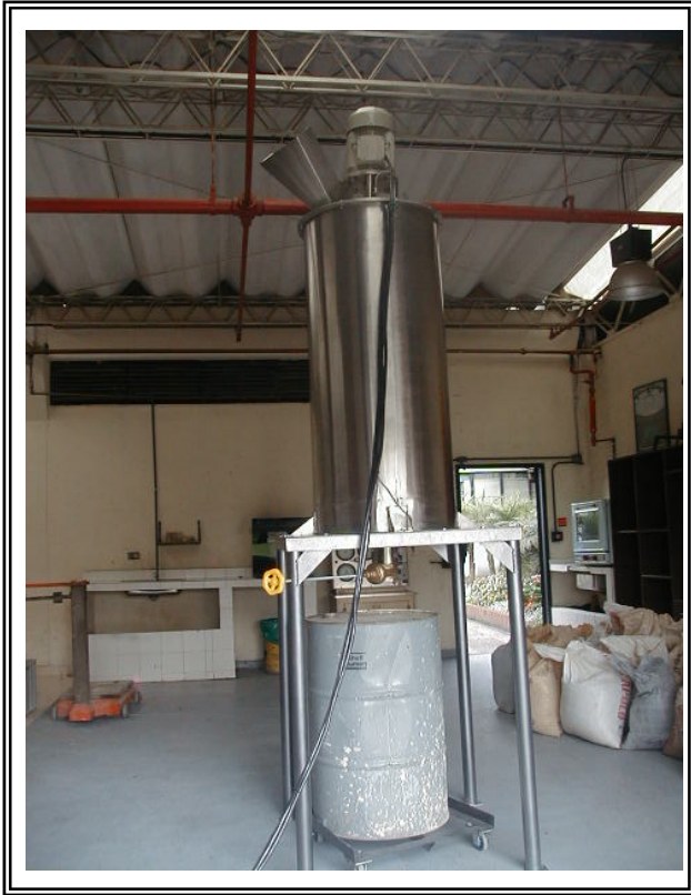
Figura D3 al anexo No. 4 Tanque reactor con motor y tolvas de alimentación
