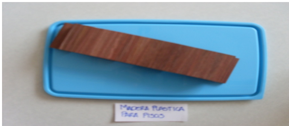
Figura 47. WPC con proceso de extrusión para pisos
