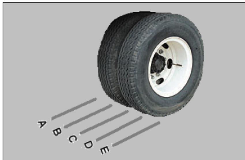
Figura 24. Esquema de los ejes por los cuales circulan en el Carrusel de Fatiga
