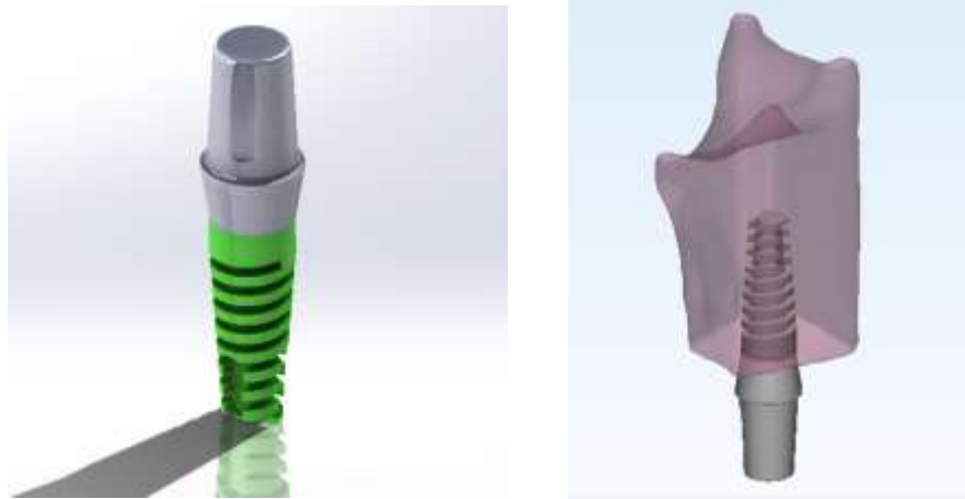
Figura 2. Modelo tridimensional del implante (a) implante y pilar, (b) conjunto tejido óseo e implante
