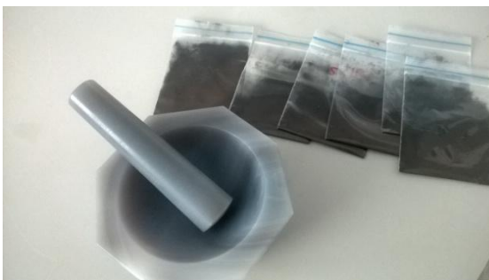
Figura 7 Preparación de la muestra para la toma de espectro IR-ATR
