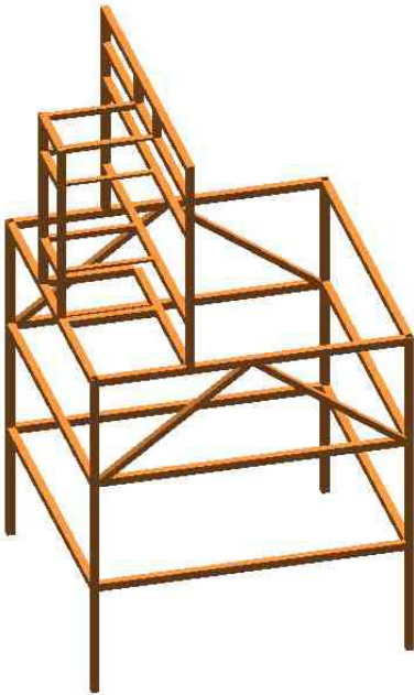
Figura 55. Estructura de soporte del diverter.
