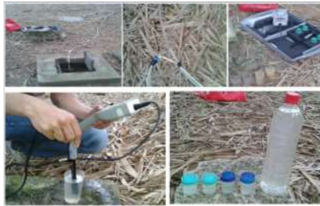
Figura 14. Proceso de toma de muestra par la calidad del agua del piezómetro 1.
