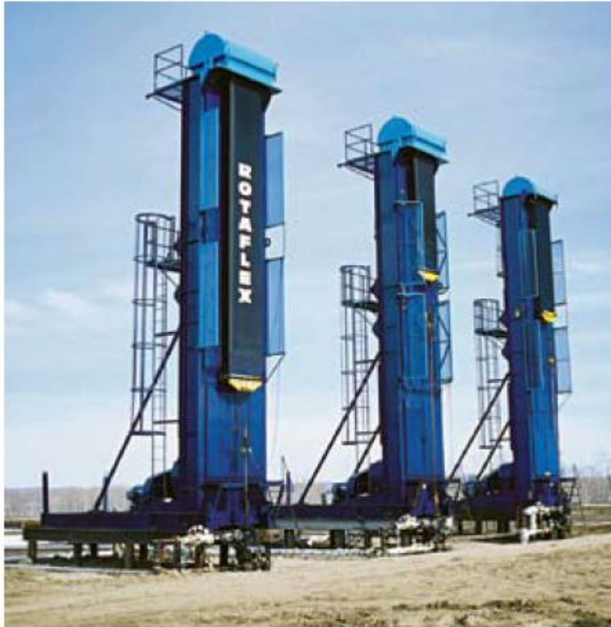
Figura 19. Nomenclatura de la Unidad de Bombeo Rotaflex.
