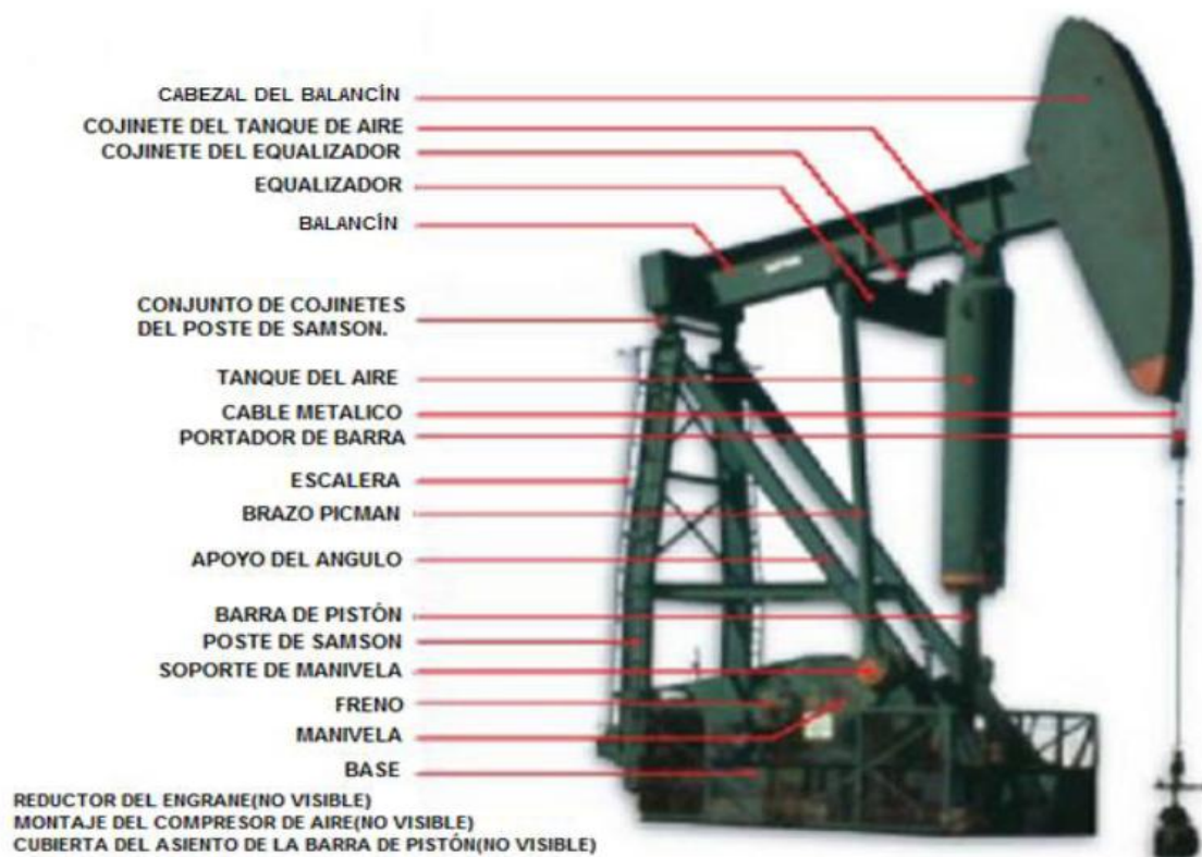
Figura 13. Nomenclatura de la Unidad de Bombeo Balanceadas por Aire
