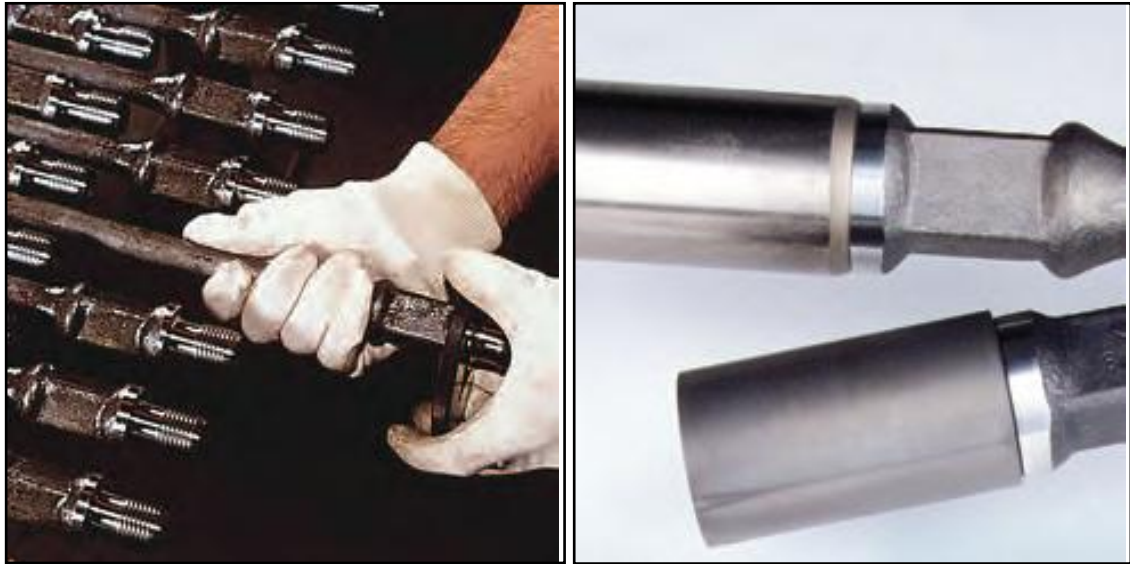
Figura 21. Sarta de varillas convencional y accesorios
