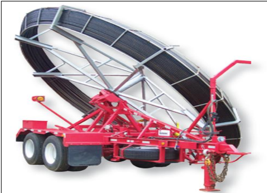
Figura 22. Sarta de varillas de continuas
