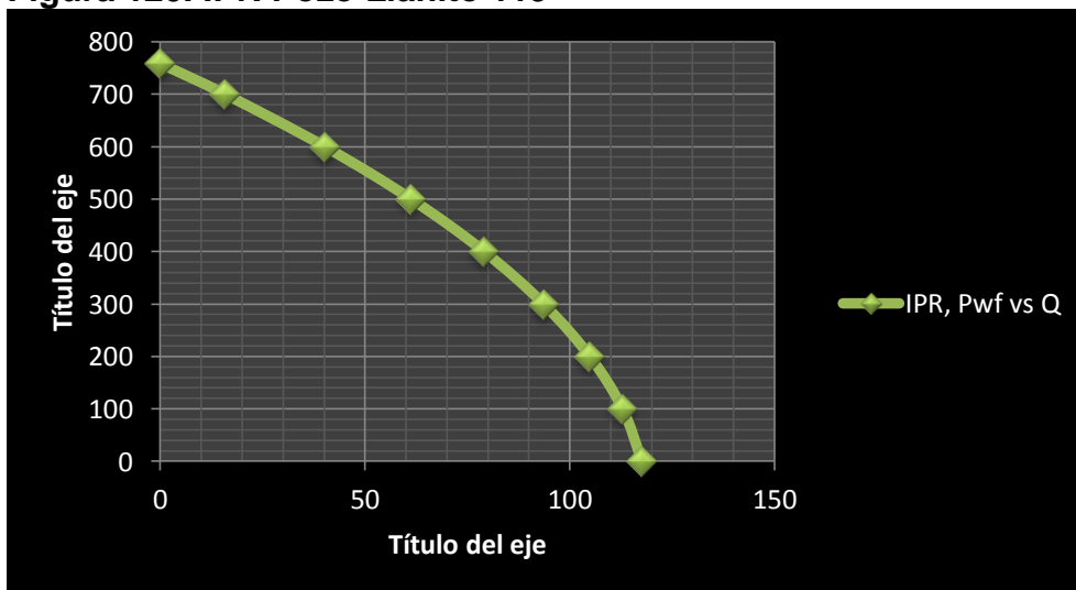
Figura 120. IPR Pozo Llanito 119
