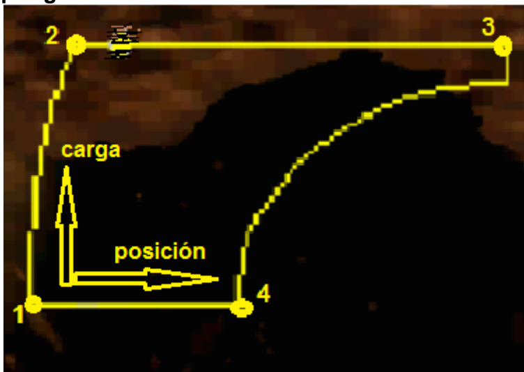
Figura 40. Carta Dinamométrica de una Bomba de subsuelo con interferencia por gas.
