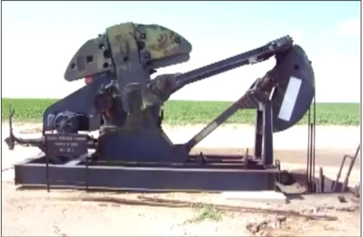
Figura 18. Unidad de bombeo de bajo perfil
